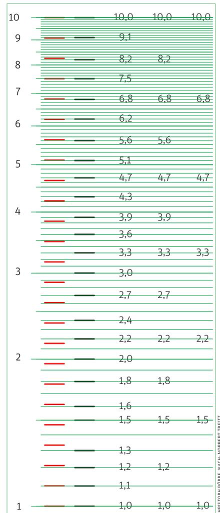
Die Handelswerte für Widerstände folgen näherungsweise einer logarithmischen Skala. Rot die Werte einer fiktiven, perfekt logarithmischen Reihe, bei der jeder Widerstand  $\sqrt[24]{10} = 1,10069$  Mal so groß ist wie sein Vorgänger.
