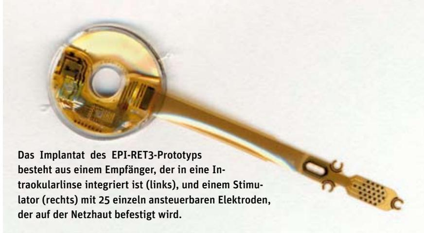
Das Implantat des EPI-RET3-Prototyps besteht aus einem Empfänger, der in eine Intraokularlinse integriert ist (links), und einem Stimulator (rechts) mit 25 einzeln ansteuerbaren Elektroden, der auf der Netzhaut befestigt wird.
