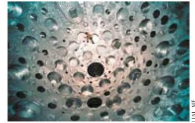
**10 Meter beträgt der Durchmesser der sphärischen Kammer im Inneren der National Ignition Facility. Hier werden bei Inbetriebnahme der Anlage 192 Laserstrahlen auf Deuterium-Tritium-Pellets treffen, um darin eine Fusionsreaktion auszulösen und Bedingungen zu schaffen, die an jene während einer nuklearen Explosion heranreichen.**
