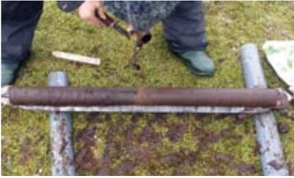
Einen Meter lang ist das Bohrkernsegment (oben) vom Torfmoor am Lago Galvarne an der Nordküste der Staaten-Insel. Die Sedimente darin haben sich über einen Zeitraum von 1400 Jahren hinweg abgelagert. Im Bohrkern vom Rand der Laguna Cascada (rechts ein Ausschnitt) erscheint in einer Tiefe von 2,80 Metern eine Lage Sand. Vermutlich haben ihn starke Niederschläge vor etwa 5500 Jahren in den See gespült.
