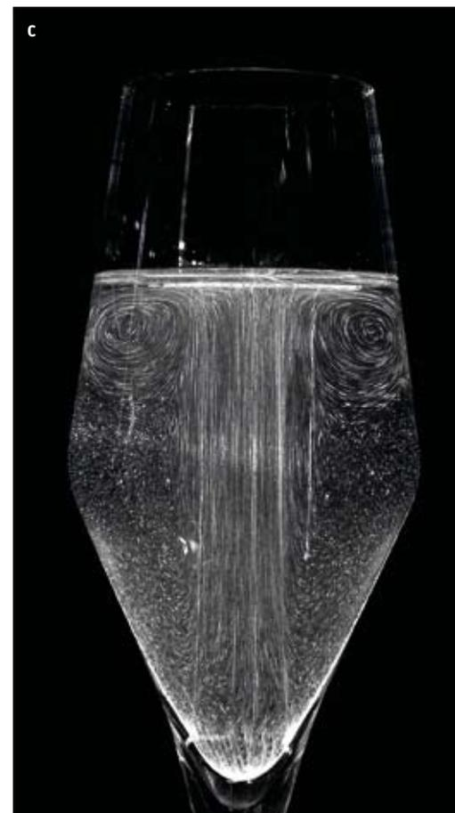
Die Blasen, die an der Oberfläche zerplatzen, lassen winzige Flüssigkeitsstrahlen in die Höhe schießen (nebenstehendes Bild), die schnell in feine Tröpfchen zerstieben und einen Nebel bilden, den wir durch die Lasertomografie sichtbar machen können (Bild rechte Seite).
