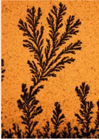
Ein Kupferbaum und dessen Simulation mit einem Algorithmus zur diffusionsbegrenzten Aggregation: Beide Strukturen haben fast dieselbe fraktale Dimension.
