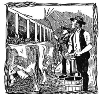
▲ Die Tüchmaschine »Fix« desinfiziert und weißt Ställe.
