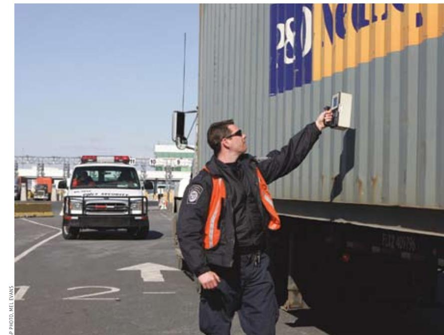
◀ Bei der Grenzkontrolle soll ein Detektor geschmuggeltes Nuklearmaterial an den Spektren der emittierten Röntgen- und Gammastrahlung erkennen (Foto). Ein herkömmlicher Halbleitersensor vermag nicht alle Isotope einer Testprobe zu unterscheiden (linkes Diagramm). Messungen mit einem supraleitenden Detektor lösen alle Spektrallinien auf (rechtes Diagramm) und identifizieren insbesondere Plutonium-239, das in Nuklearwaffen verwendet wird.
