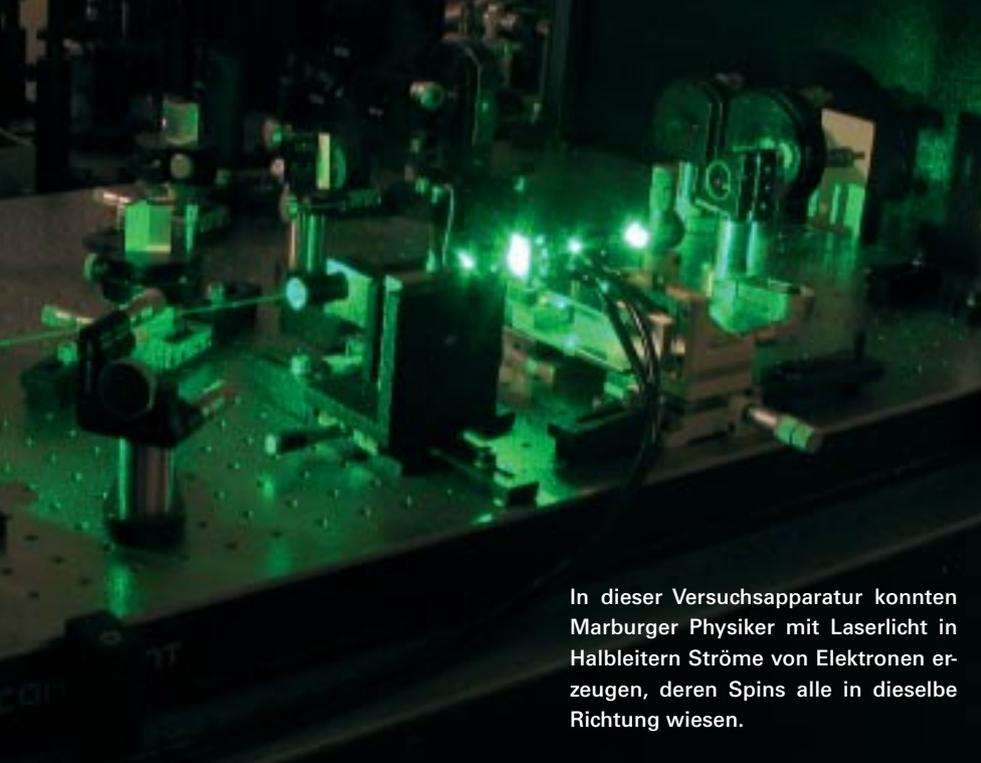
In dieser Versuchsanordnung konnten Marburger Physiker mit Laserlicht in Halbleitern Ströme von Elektronen erzeugen, deren Spins alle in dieselbe Richtung wiesen.
