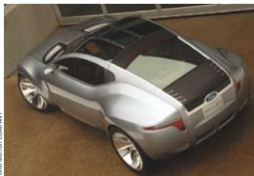
◀ Diesel-elektrische Hybridautos, wie diese Studie »Reflex« von Ford, erreichen einen viel geringeren Benzinverbrauch als ein benzin-elektrischer Hybrid. Das Fahrzeug nutzt auch Solarflächen in den Frontscheinwerfern und Rückleuchten, um zusätzlich Bordenergie für Aggregate und Batterie zu erzeugen.
