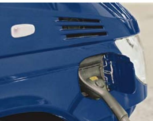
◀ Den ersten am Netz aufladbaren Hybriden stellte Mercedes-Benz 2005 mit seinem Transporter vom Typ Sprinter vor. Hinter einer Klappe verbirgt sich der Elektroanschluss, über den die Batterie in der Nacht mit einer Stromquelle verbunden werden kann.
