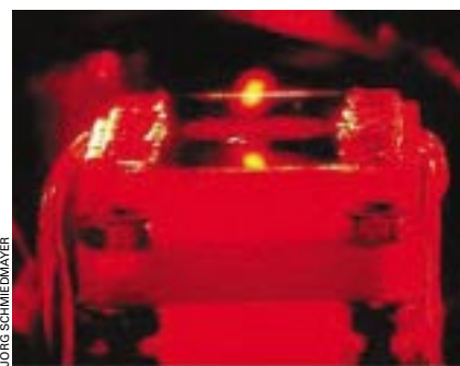
▲ Im Labor von Jörg Schmiedmayer an der Universität Heidelberg schwebt eine Wolke kalter Lithiumatome über einem Atom-Chip. Die goldbeschichtete Oberfläche des Galliumarsenid-Chips erzeugt ein Spiegelbild der Wolke.
