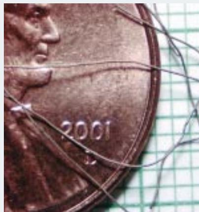
**Dünne Drähte lassen sich durch Einwirken von Magnesiumdampf auf Borfasern herstellen.**
