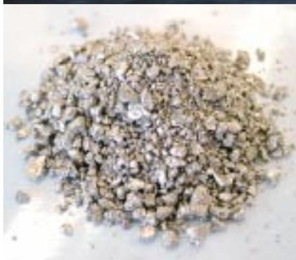
▲ In der Marine hat die Zukunft schon begonnen: Weil Brennstoffzellen-U-Boote länger unter Wasser bleiben können als solche mit Dieselantrieb, testet die Howaldtswerke Deutsche Werft (HDW) in Kiel die noch kostspielige Speicherung von Wasserstoff in Metallhydriden (links).
