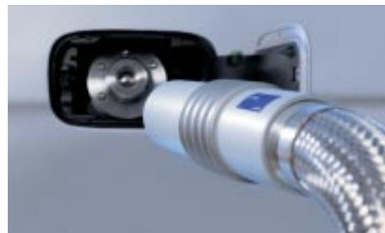
▶ Sie sind Thermoskannen der Superlative: LH<sub>2</sub>-Kryotanks (rechts) bestehen aus doppelwandigen Metallbehältern; der Raum zwischen den Schalen ist evakuiert und zudem mit Lagen aus Glasvlies thermisch isoliert. Damit lässt sich Wasserstoff über längere Zeit bei -253 Grad Celsius speichern. Eine Heizung und Ventile sorgen für die geregelte Gasabgabe. Auch der Tankvorgang (oben) wirft keine technischen Probleme mehr auf.
