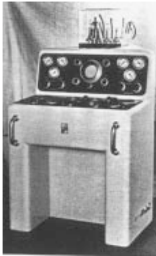
▲ Unter der Plexiglashaube des »Künstlichen Herzens« befinden sich vier Pumpen aus Glas.
