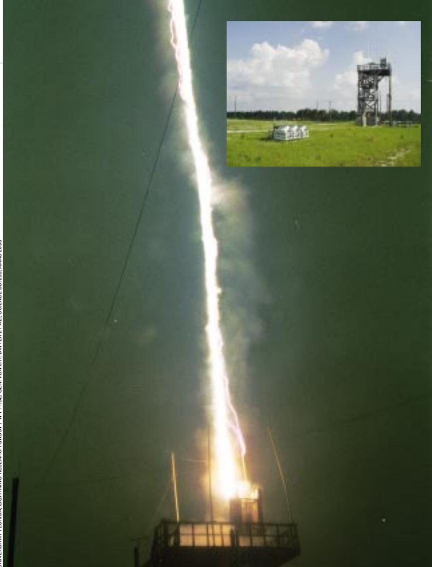
▲ Künstlicher Blitz auf dem Versuchsgelände in Florida: Von einem Holzturm (kleines Bild) startet eine Rakete, die einen stromführenden Draht hinter sich her zieht. Dieser bildet einen leitenden Kanal für die Blitzentladung. Messinstrumente registrieren Energie und Intensität der dabei emittierten Röntgenstrahlung.
