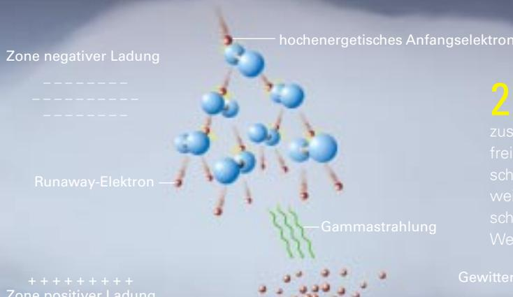
**2** Stößt eines dieser Teilchen wie etwa ein energiereiches Elektron in einer Gewitterwolke mit einem Luftmolekül zusammen, setzt es weitere hochenergetische Elektronen frei. Diese werden in den elektrischen Feldern, die zwischen den Zonen negativer und positiver Ladung auftreten, weiter beschleunigt. Als Folge entsteht eine Lawine immer schnellerer Elektronen (*runaway electrons*), die auf ihrem Weg durch die Wolke Gammastrahlung emittieren.
