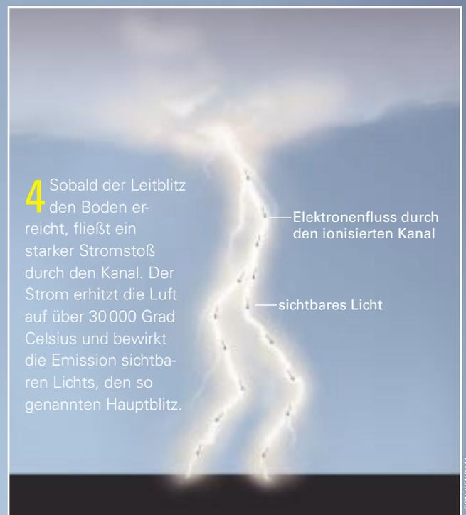
**4** Sobald der Leitblitz den Boden erreicht, fließt ein starker Stromstoß durch den Kanal. Der Strom erhitzt die Luft auf über 30 000 Grad Celsius und bewirkt die Emission sichtbaren Lichts, den so genannten Hauptblitz.
