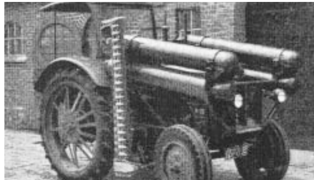
▲ Für Biogasbetrieb umgebauter Traktor: Das Gas wird in Flaschen gefüllt, die auf dem Schlepper angebracht sind.
