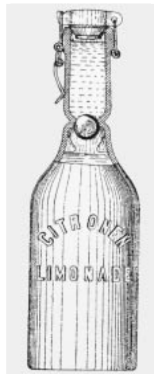
▶ Eine Kugel trennt den süßen Saft vom spritzigen Mineralwasser.
