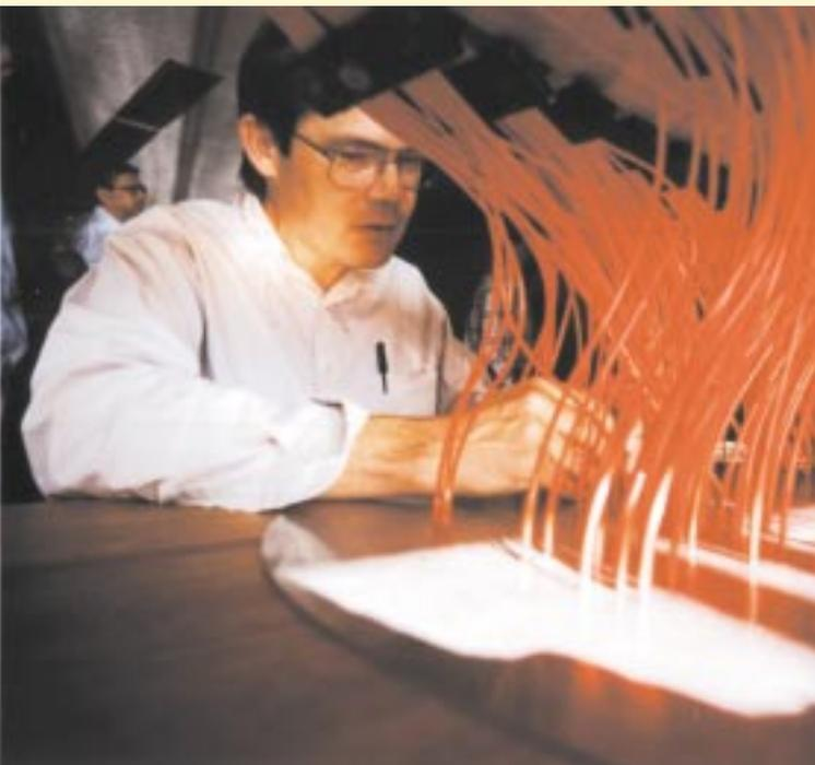
**Optische Leiter** führen in eine Metallplatte mit 640 Löchern. Jede dieser Glasfasern führt das Licht eines Himmelskörpers zum Spektrografen, der in weniger klaren Nächten genutzt wird.
