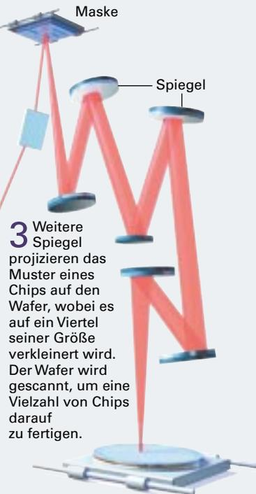
**3** Weitere Spiegel projizieren das Muster eines Chips auf den Wafer, wobei es auf ein Viertel seiner Größe verkleinert wird. Der Wafer wird geschnitten, um eine Vielzahl von Chips darauf zu fertigen.
