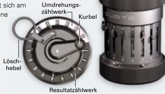
der und so die Übertragungsachsen dreht. Über den Triebstock wird die Drehung auf die Rädchen der Zählwerke des Rundwagens übertragen. Im Resultatzählwerk steht nun die Zahl 32, während im Umdrehungszählwerk die Zahl der Operationen angezeigt wird – also 1.
