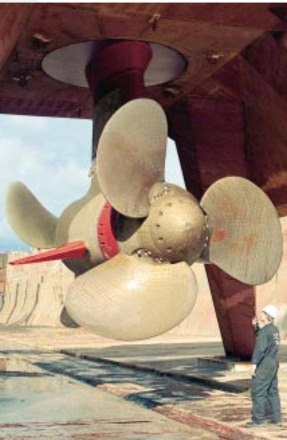
Ein moderner Pod-Schiffsantrieb wird von Elektromotoren in Gang gesetzt. Wenn sich im Innern der Gondel ein supraleitender Motor befände, könnte sie noch kompakter und damit strömungsgünstiger konstruiert werden.
