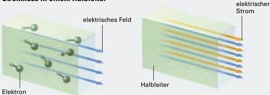
Wird eine Spannung an die Enden einer Halbleiterplatte (grün) angelegt, entsteht ein elektrisches Feld (blaue Pfeile). Elektronen beginnen daraufhin durch das Material zu driften.
