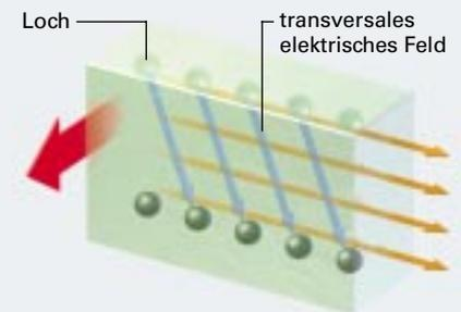
Die gekrümmten Wege bewirken zudem, dass sich Elektronen an der Unterseite und Löcher (positiv geladene Elektronenfehlstellen) an der Oberseite der Platte sammeln. Das wiederum erzeugt ein transversales elektrisches Feld und die Ebene des Stromflusses kippt.
