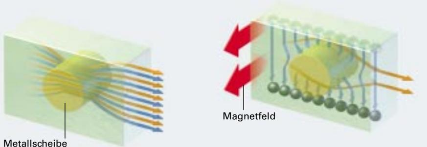
Elektrische Felder stehen immer senkrecht auf einer Metalloberfläche. Eine Scheibe aus Gold im Halbleiter stört deshalb die Feldlinien und bündelt den Stromfluss. Nun können mehr Ladungsträger durch die Struktur transportiert werden, ihr elektrischer Widerstand ist also sehr gering.
