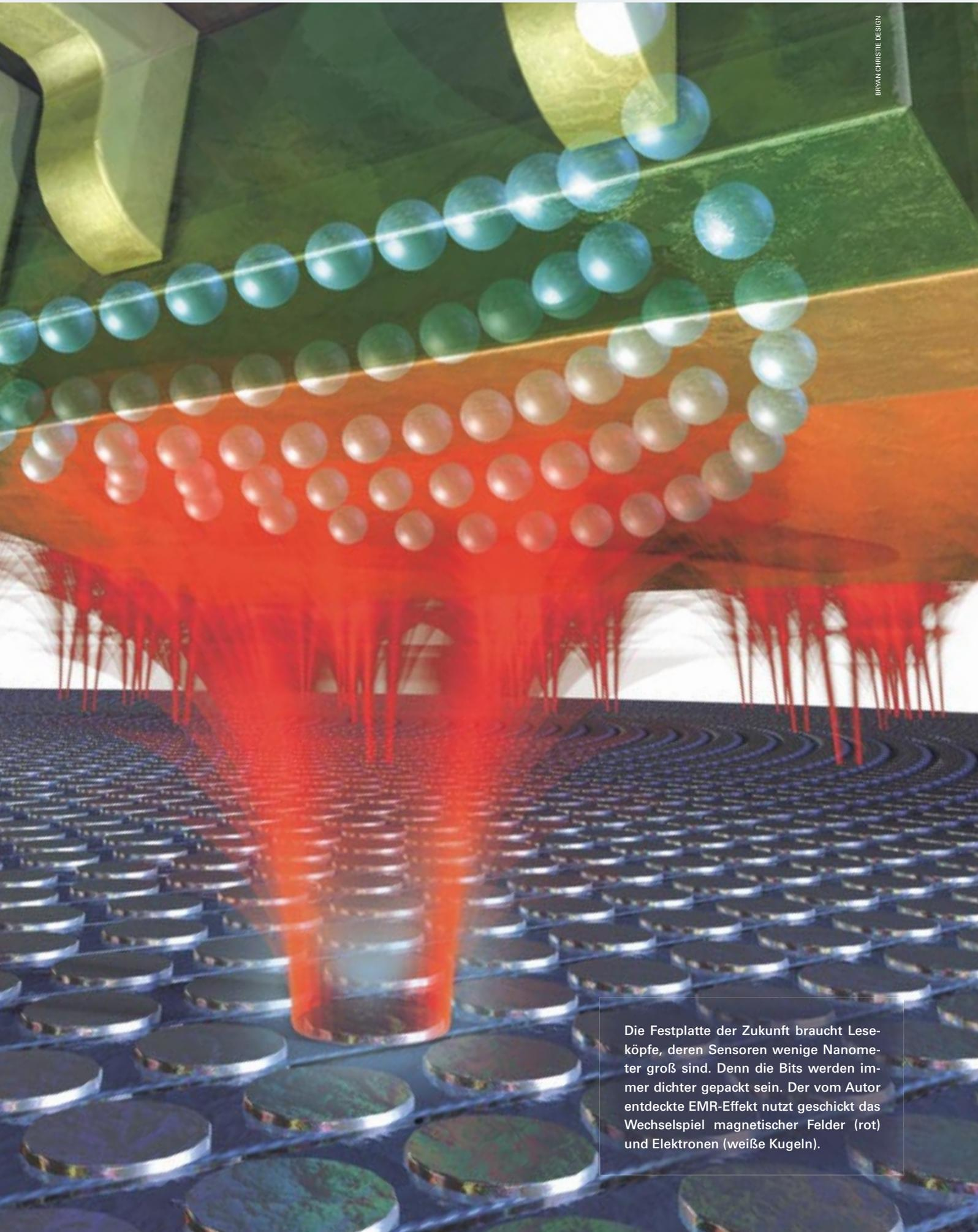
Die Festplatte der Zukunft braucht Leseköpfe, deren Sensoren wenige Nanometer groß sind. Denn die Bits werden immer dichter gepackt sein. Der vom Autor entdeckte EMR-Effekt nutzt geschickt das Wechselspiel magnetischer Felder (rot) und Elektronen (weiße Kugeln).
