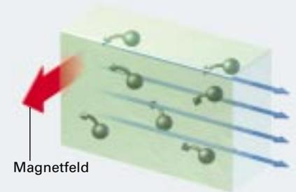
Ein magnetisches Feld (roter Pfeil) senkrecht zur Platte krümmt die Elektronenbahnen. Das verlängert deren Weglänge und verringert somit die durchschnittliche Driftgeschwindigkeit. Der Stromfluss nimmt ab, was einem Magnetowiderstand entspricht.
