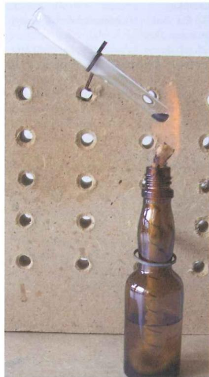
Abb. 1: Quantitative thermische Zersetzung im Glühröhrchen
