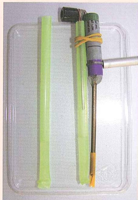
Abb. 4: Strohhalm-Halbzelle und Kombination von Strohhalmhalbzelle mit einer Platinelektrode, die in eine Kugelschreibermine eingeklebt ist. Mit einer passenden Klammer lassen sich beide gemeinsam am Galgenstativ [2] befestigen.
