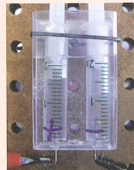
Abb. 5: Ein Stadium der Elektrolyse von gesättigter Natriumsulfatlösung: V(+)=0,3 mL, V(-)=0,8 mL. Regelmäßig ist V(+), um etwa 0,1 mL kleiner als der Erwartung entspricht, vor allem, weil Sauerstoff besser in Wasser löslich ist als Wasserstoff.
