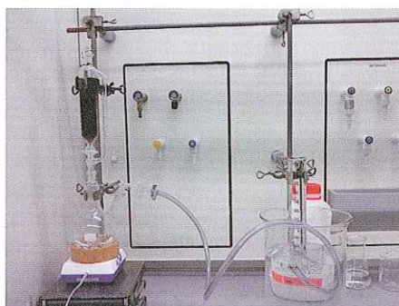
Abb. 11: Foto und schematischer Aufbau der Scheibler-Apparatur zur Bestimmung des CO 2 -Gehaltes des Sprudelwassers
