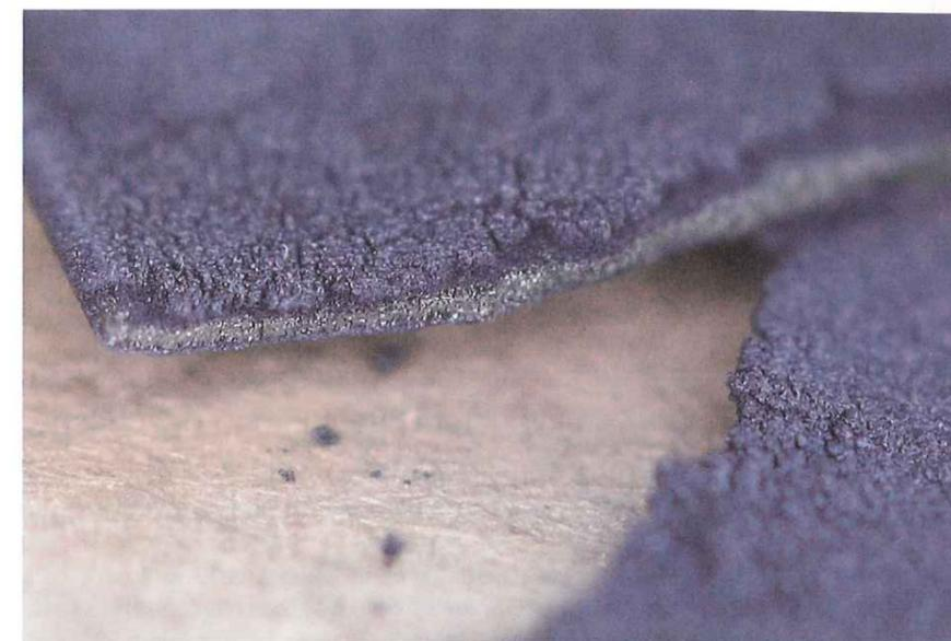
Abb. 6: Reaktionsprodukt tief bläuliches Kupfer(I)-sulfid
