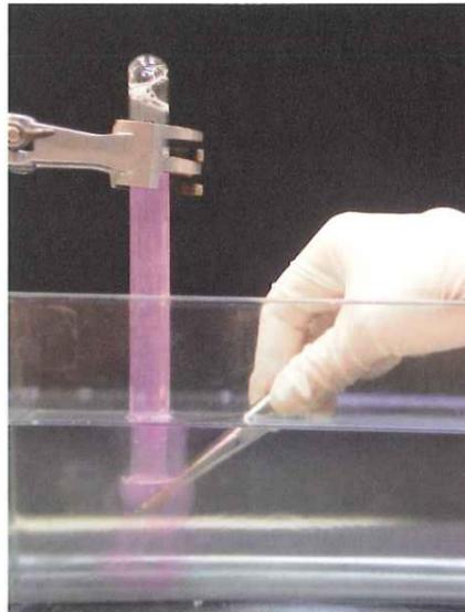
Abb. 2: Pinzette mit Lithium unter Wasser
