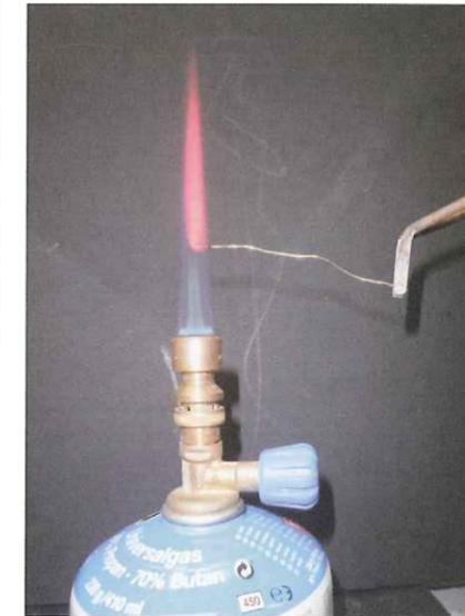
Abb. 6: Büroklammer mit Alkalimetallsalz
