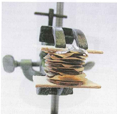
Abb. 2: Experimenteller Aufbau der Volta'schen Säule
