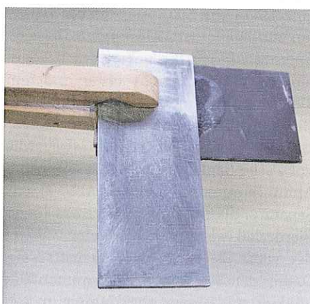
Abb. 3: Experimenteller Aufbau des Leclanché-Elementes
