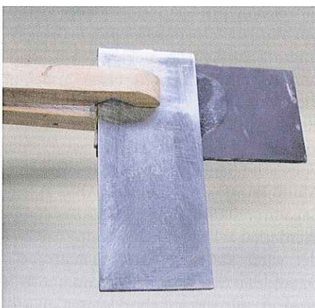
Abb. 3: Experimenteller Aufbau des Leclanché-Elementes
