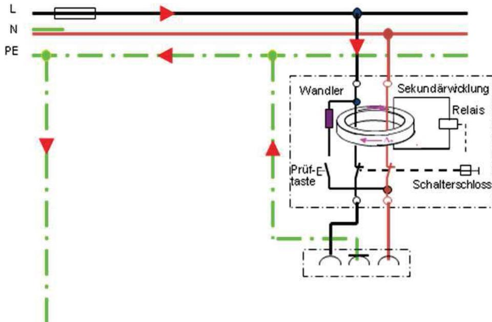
Abb. 27: Funktion einer Fehlerstrom-Schutzeinrichtung (RCD)
