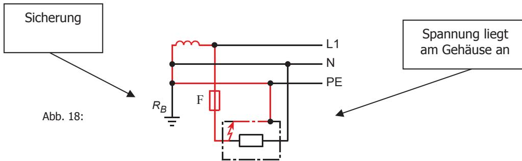
Prinzip des Schutzes durch automatische Abschaltung der Stromversorgung im TN-S-System
