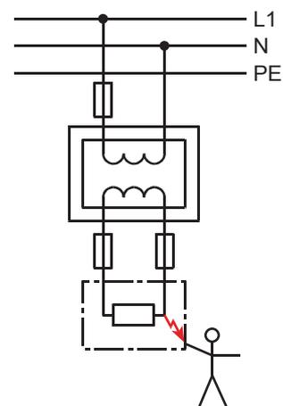
Als Voraussetzungen für die Schutztrennung muss eine sichere Trennung vom (geerdeten) Versorgungsnetz gewährleistet sein.
