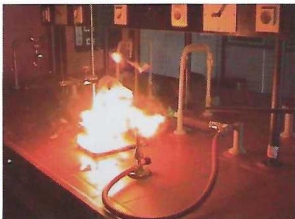
**Bild 1:** In die Brennerflamme wird Lycopodium gepustet.
