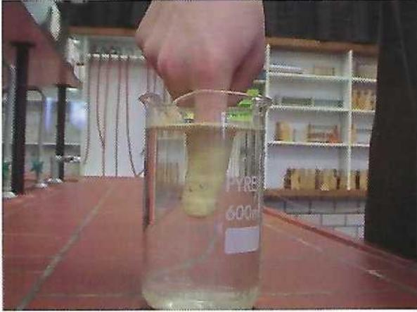
**Bild 1:** Finger taucht in Wasser, das mit Lycopodium überzogen ist.
