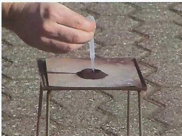
**Bild 1:** Einige Tropfen Glycerin auf fein gepulvertes Kaliumpermanganat ...
