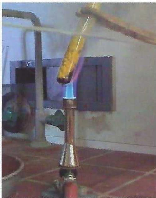
**Bild 1** Eisenoxalat wird erhitzt bis es schwarz wird.
